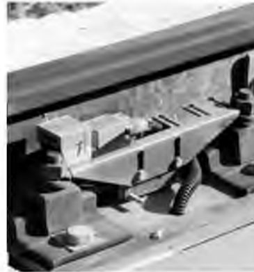
Динамические железнодорожные весы американской фирмы «Меттлер Толедо» – главное новшество пункта весового контроля
