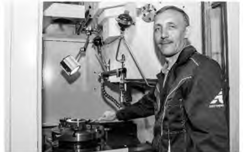
Зуборезчик Олег Богославский занят обработкой зубчатой обоймы для цеха №23 на зубодолбежном станке LS-426
